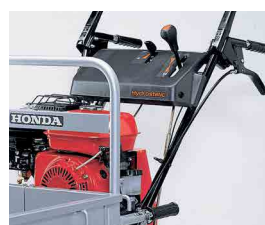
Das hydrostatische Getriebe erleichtert vieles
