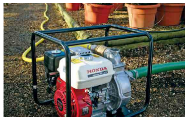
Die WH Modelle liefern bis zu 5 bar Druck, ideal für lange Transportwege
