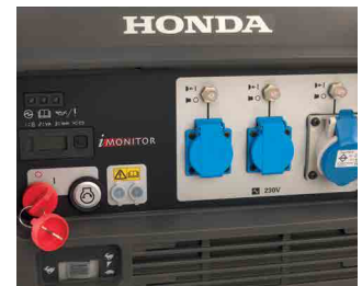
Drücken Sie den Schalter, um den Motor zu starten
