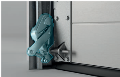
Sicherheitsbremse Verhindert das Herabfallen des Tores bei Seilbruch (ab 9m² Standard).
